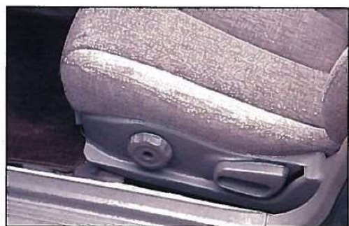
De zitting van de bestuurdersstoel is kantelbaar, de leuning kan niet traploos worden versteld.
