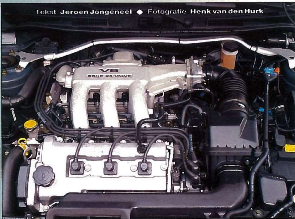
De tweeliter zescilinder ligt dwars onder de motorkap, levert 146 pk en is fluissteril.
