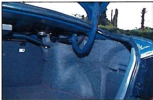
De beugels van het kofferbakdeksel draaien in de bagageruimte.
