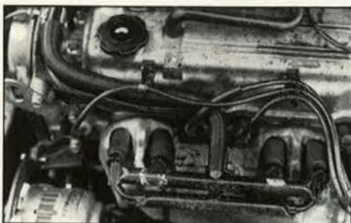
Vier pijpjes op het uitlaatspruitstuk zorgen ervoor dat extra lucht een naverbranding van de uitlaatgassen teweeg brengt.
